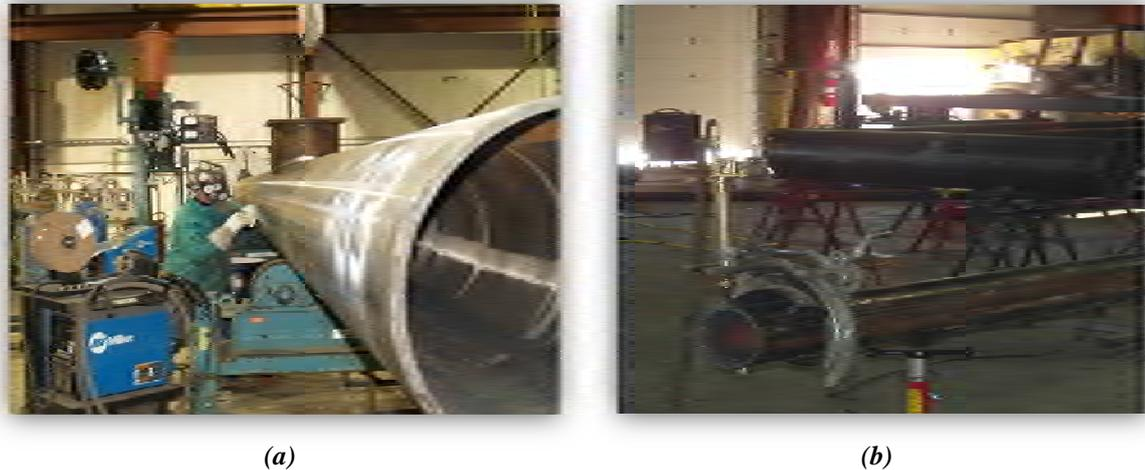
**Figure. II.6.** (a) : la soudure manuelle des tubes, (b) : la soudure automatique par machine des tubes.
