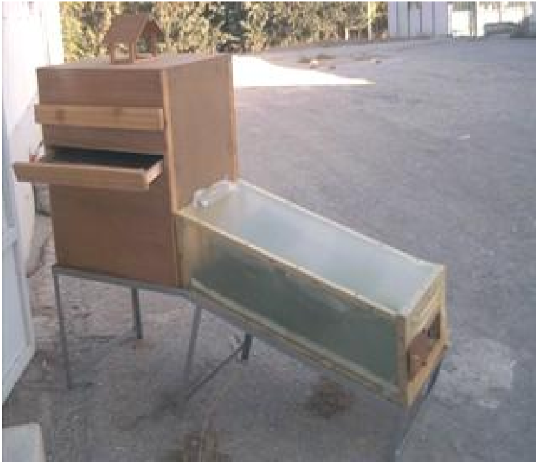
Figure 3 b : Photo du séchoir solaire avec ses deux éléments
