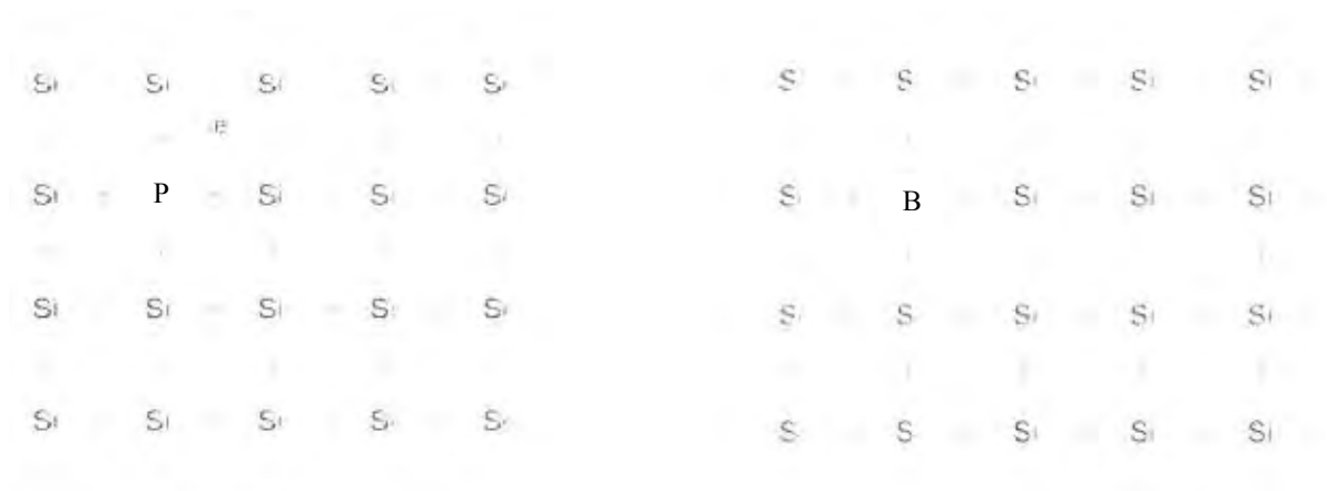
Fig. I.4 : Dopage du silicium par du Phosphore (N) et du Bore (P).
