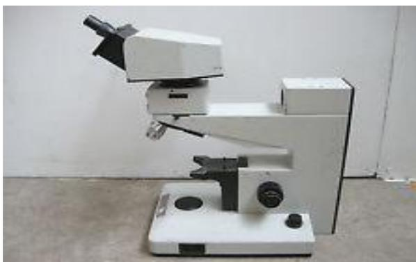
Figure III.1 : Microscope optique à grand champ du type Zeiss.
