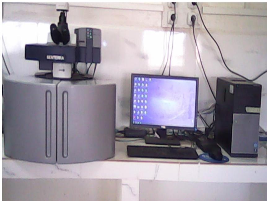
Fig. 43. Spectromètre Raman.
