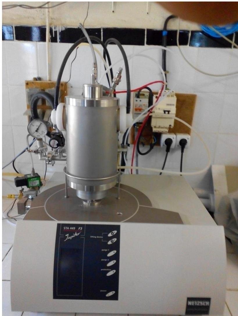
Fig. 42: L'appareil d'analyse calorimétrique différentielle Netzsch STA 449 F3 Jupiter.
