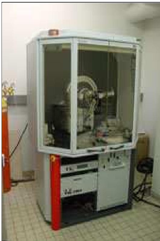
**Fig. III.4 :** Diffractomètre de type (BRUKER - AXS type D8).
