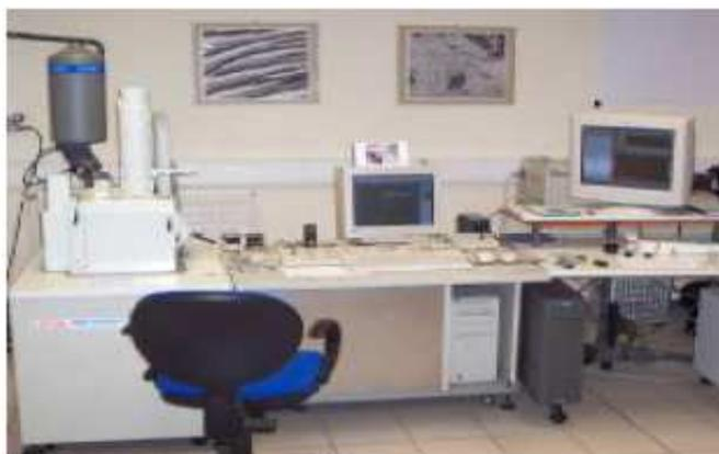
**Fig. III.10 :** Microscope électronique à balayage (MEB).
