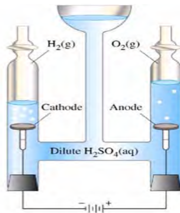
Figure I.7. Principe de l'électrolyse de l'eau.
