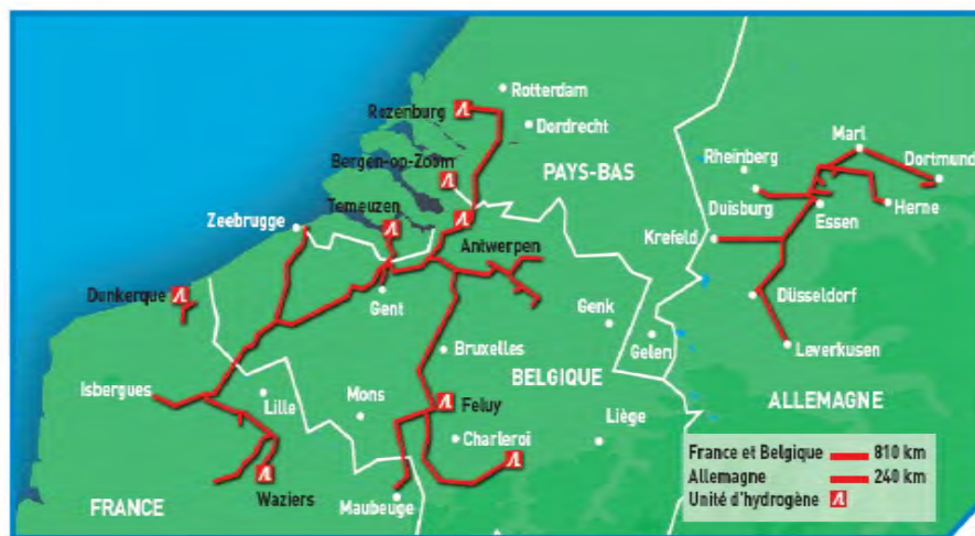
Figure. I.10. Réseau de canalisation d'air liquide. [1]
