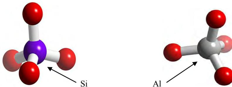
**Figure. I.3 :** Représentation schématique des unités de construction primaires des zéolithes, adapté de [23].
