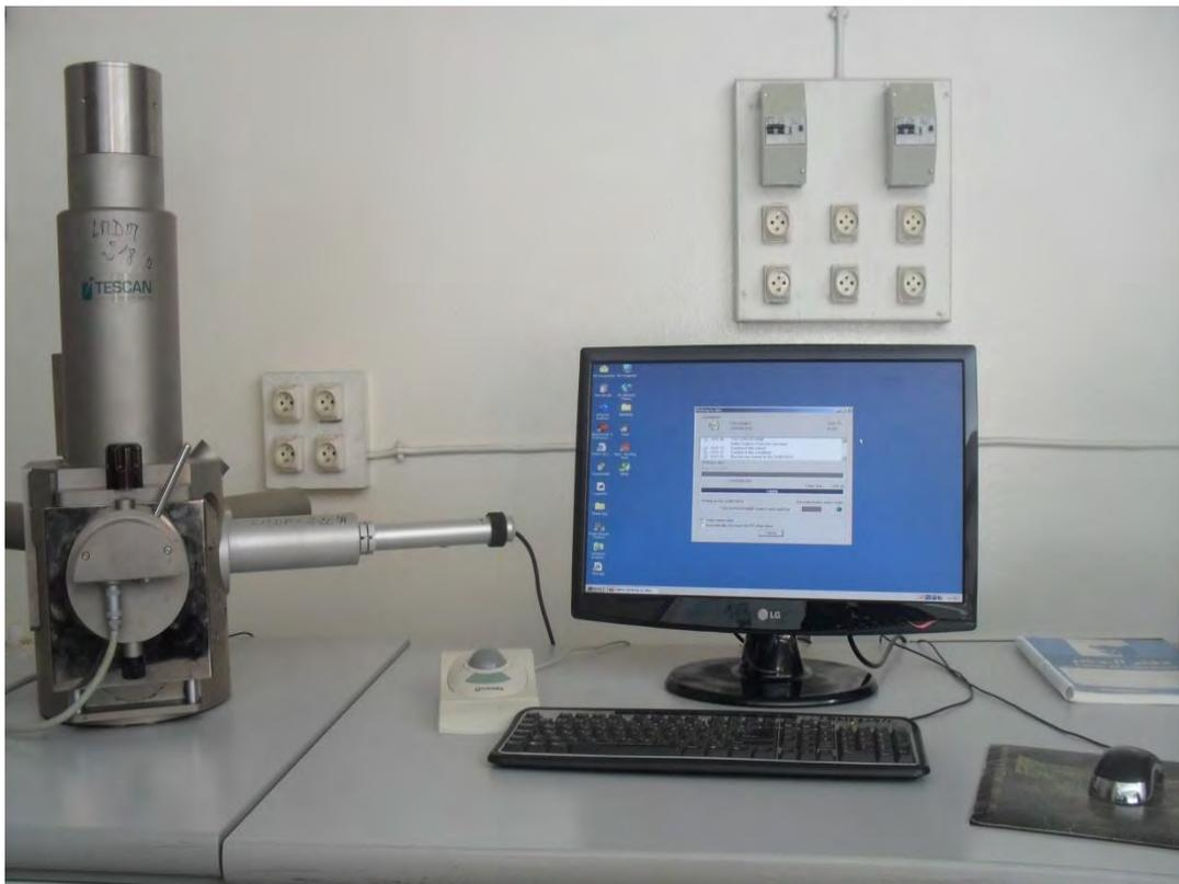
**Figure II.1:** Microscope électronique à balayage (MEB).
