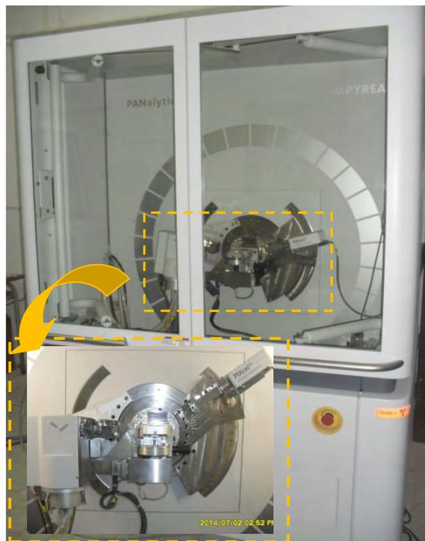
**Figure II.5:** Diffractomètre de marque EMPYREAN.
