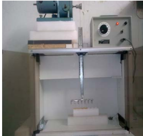
Figure III.5 : Dispositif de dépôt des couches minces par dip-coating (conception et mise au point au laboratoire).
