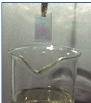
Figure III.6: Les différentes étapes de la formation d'une couche mince par la méthode de trempage-tirage : le substrat est situé au dessus du récipient contenant la solution (1), puis il est immergé dans le liquide (2). Après avoir attendu quelques minutes la stabilisation de la surface de la solution, il est procédé à la remontée du substrat (3). Le liquide s'écoule alors uniformément, laissant apparaître le film uniforme et poreux (4). Ce film est formé après l'évaporation des solvants les plus volatils (5).
