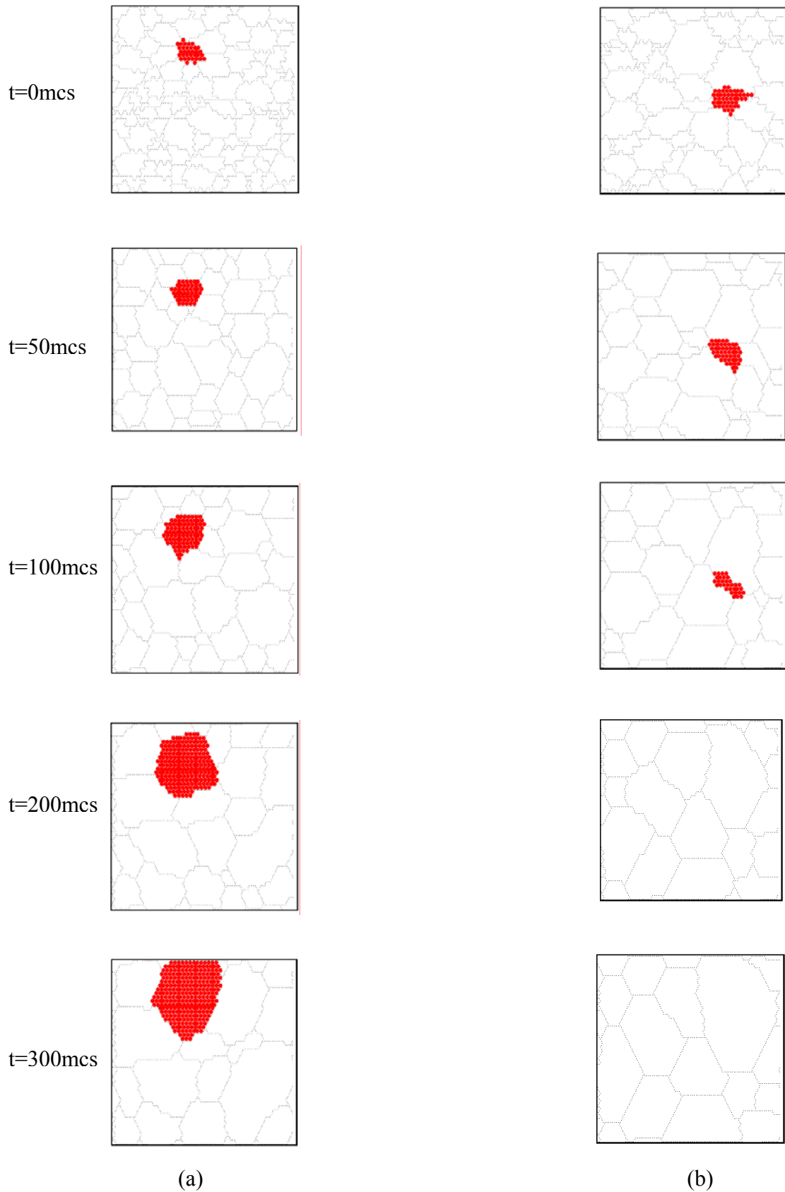
Figure IV.16 : La croissance d'un grain de la zone 1 (a) et la décroissance d'un autre grain de la zone 2 (b) jusqu'à sa disparition. Le grain en croissance dans la zone 1 ne bénéficie pas au départ d'une taille plus importante que celui de la zone 2.
