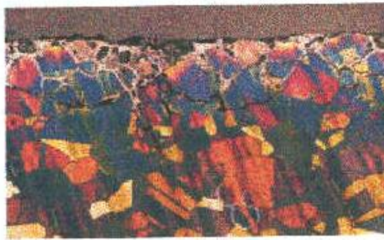
Fig. I.19 : Corrosion intergranulaire d'un inox par HCl
