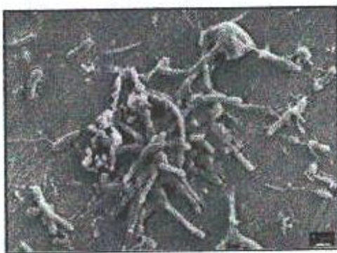
Fig. I.23 : Colonie de Desulfovibrio vulgaris sur acier inoxydable
