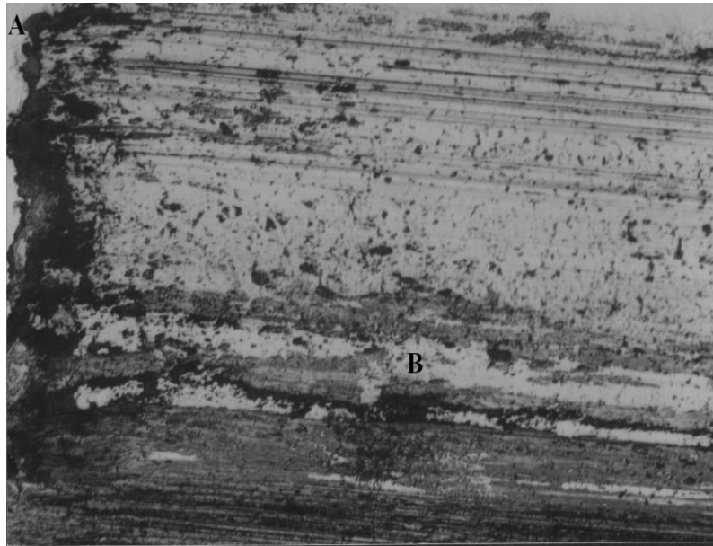
Fig.IV.44 : Image microscopique de la surface du Stellite après l'essai tribologique (X10).
