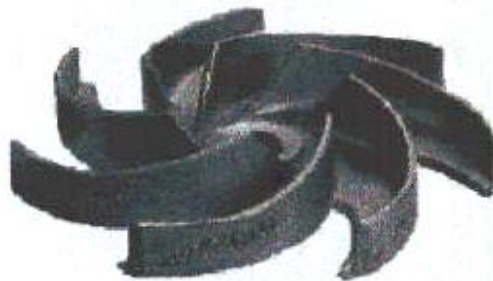
Fig. I.21 : Corrosion-cavitation d'une aube de pompe
