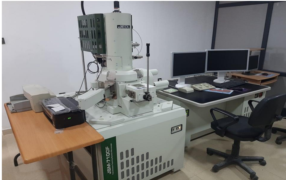
Figure 35 : La microscopie électronique à balayage (MEB) [4].
