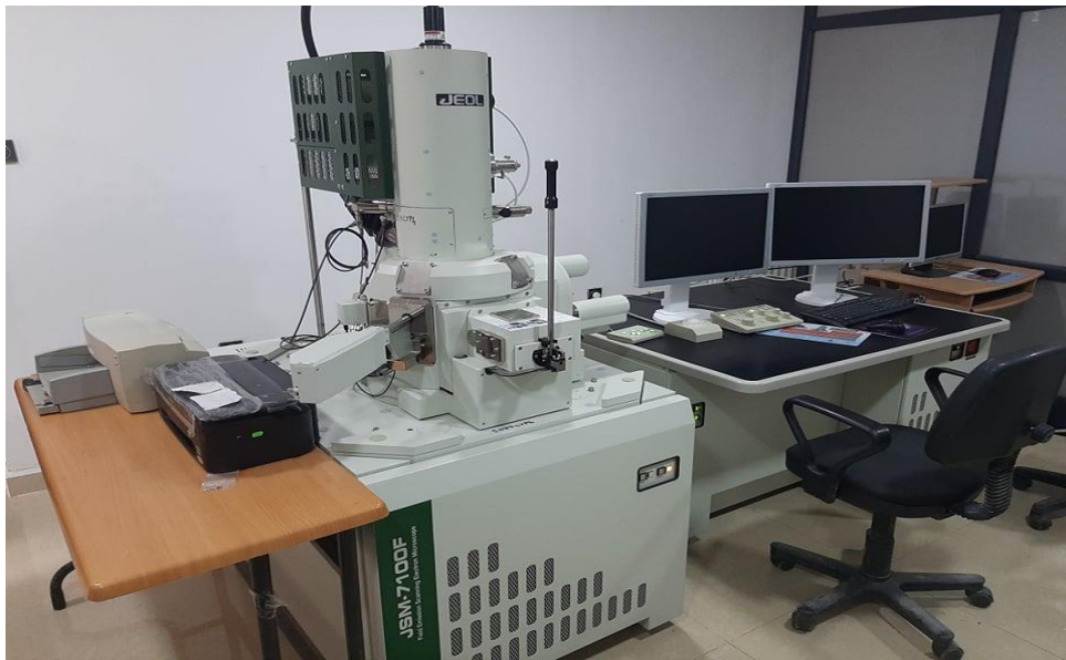
Figure 36 : La Spectroscopie de rayons X à dispersion d'énergie avec le MEB [4].
