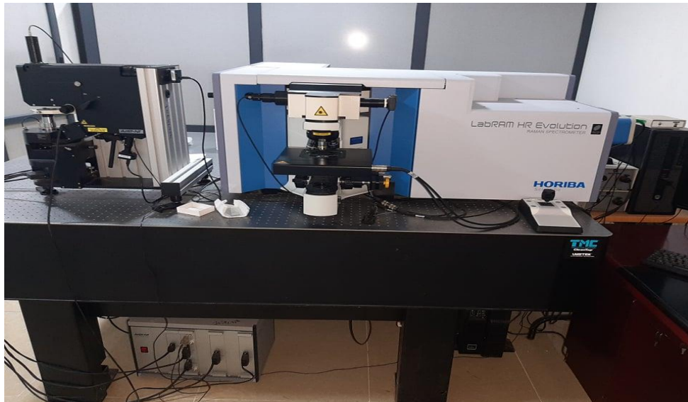
Figure 37 : La spectroscopie du Raman [4].
