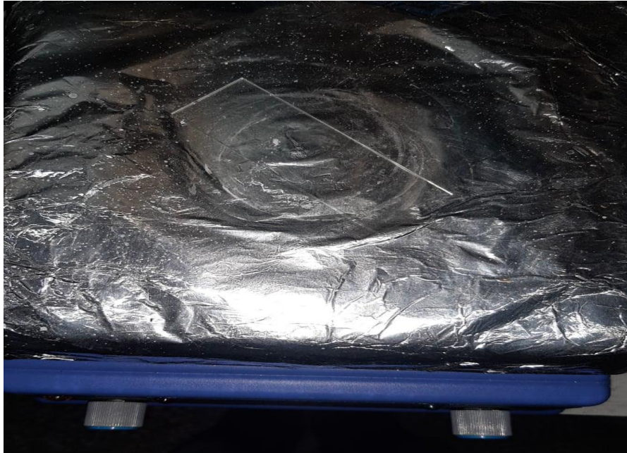
Figure 44 : Séchage de la solution sur un substrat par une plaque chauffante [4].
