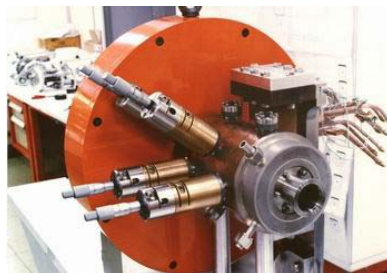
Figure II-8 Photo du solénoïde qui permet la focalisation du faisceau d'électrons vers la section accélératrice HF.
