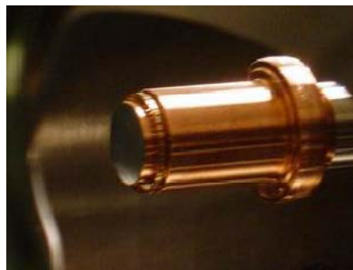
Figure II-7 Image du dépôt en tellure de césium sur la photocathode
