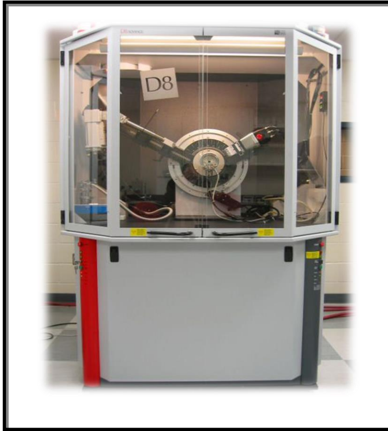
الشكل III- 10 جهاز حيود أشعة X المستعمل
