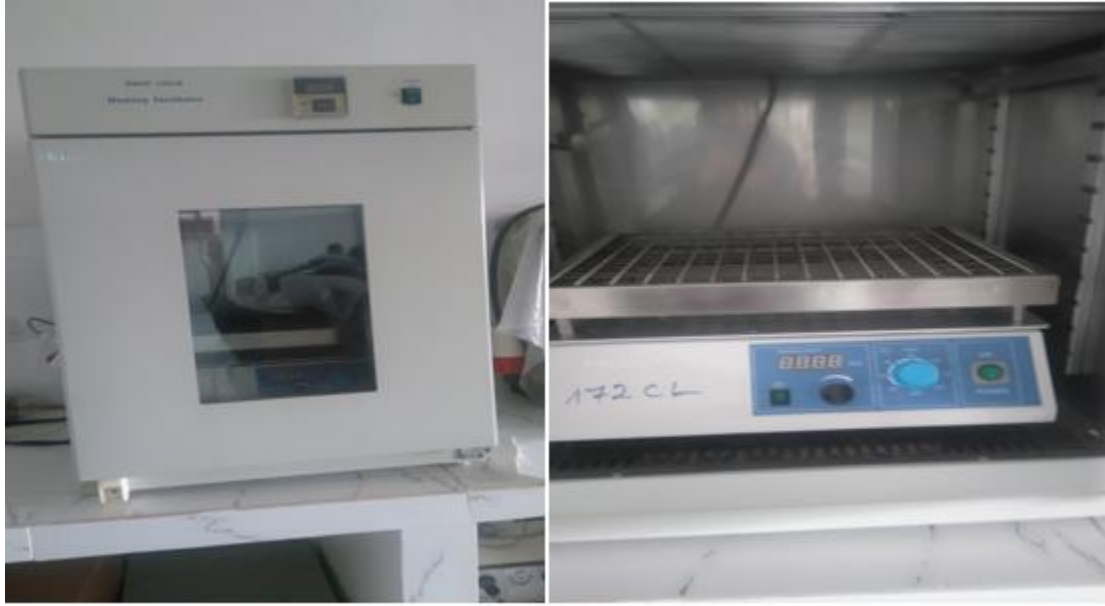
الشكل III-9- جهاز اهتزاز مخصص لوضع العينات المغموسة في SBF
