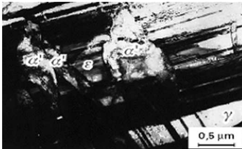
Figure III.16- Micrographie électronique montrant les bandes de martensite \varepsilon et les îlots de martensite \alpha' formés au cours de la déformation plastique d'un acier inoxydable austénitique [81].
