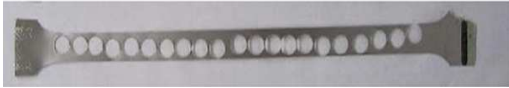
Figure IV.16- Poinçonnage des échantillons pour les tests de corrosion.
