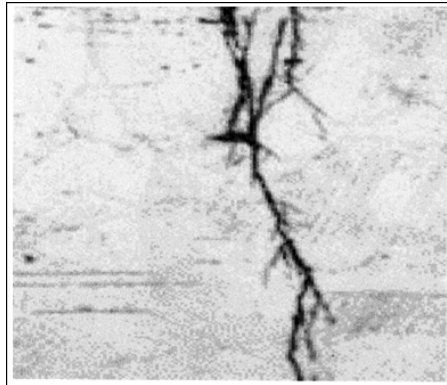
Figure II.1- Corrosion sous contrainte d'un acier inoxydable [23].
