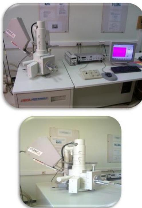
**Figure II.10.** Photographie du microscope électronique à balayage
