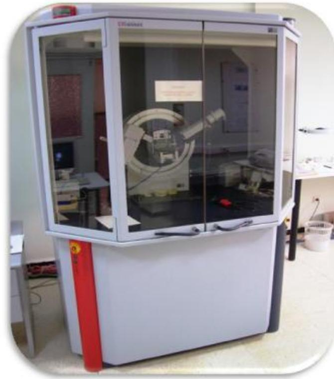
**Figure II.7.** Diffractomètre Brukers D8 Advance
