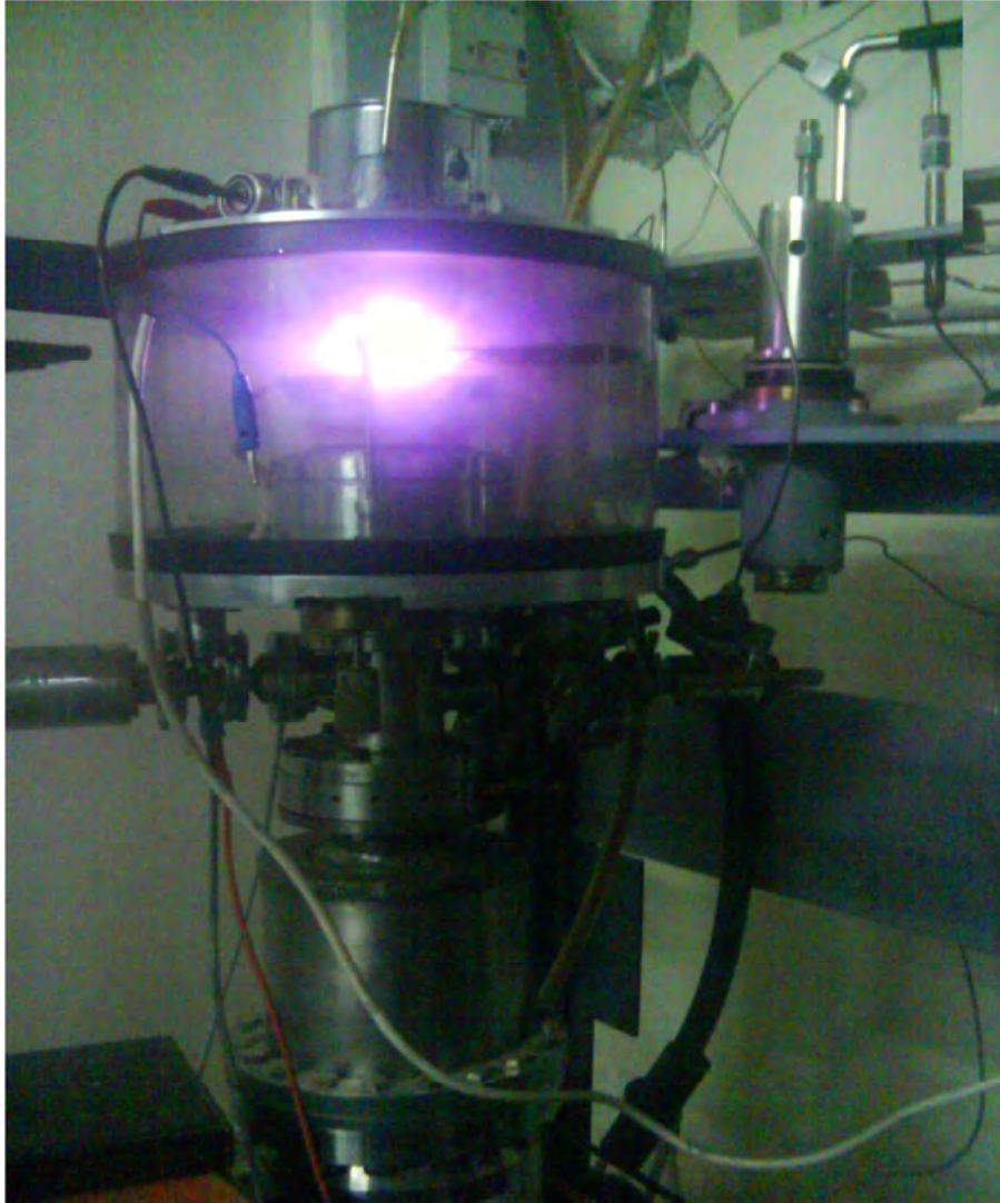
Figure II.10 Photo et schéma des enceintes de pulvérisation utilisées.
