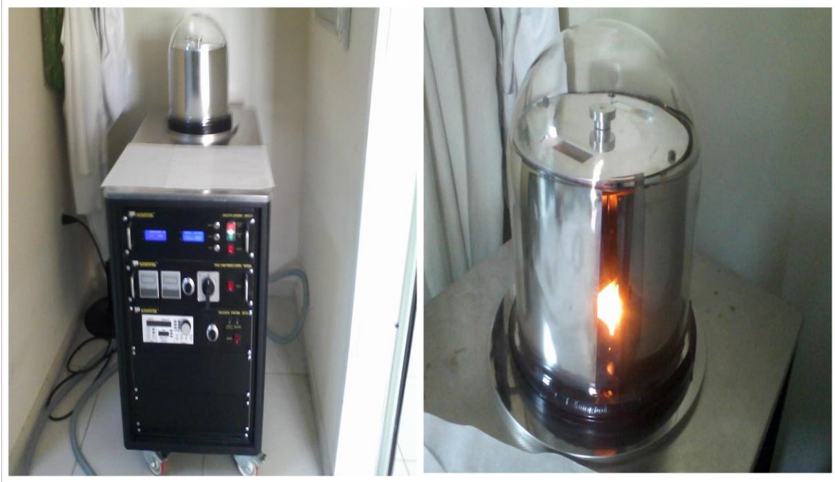
Figure II.4 Le système d'évaporation thermique sous vide pendant le dépôt des contacts métalliques.
