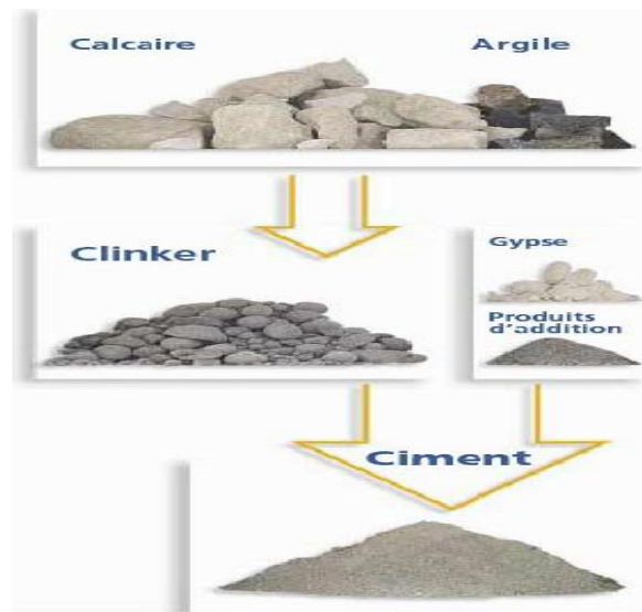
Figure 2-1 : Processus de fabrication du ciment
