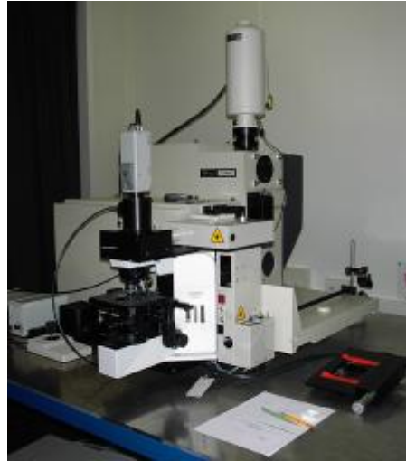
figure 2-16: Dispositif micro- Raman utilisé.
