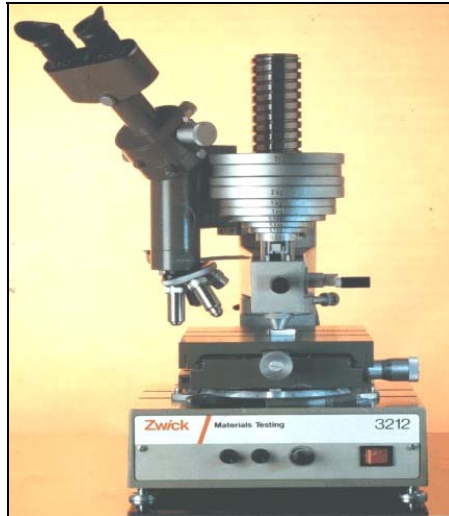
Figure III.5 : Microduromètre semi automatique du type ZWICK à pénétration Vickers.
