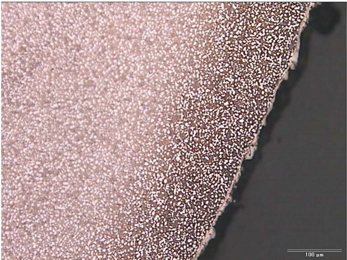
Figure IV.35 : Coupe transversale de l'alliage Ti-6Al-4V nitruré.
