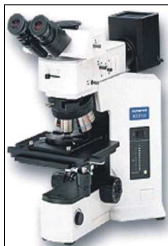
Figure III.3 : Microscope métallographique OLYMPUS BX51M.
