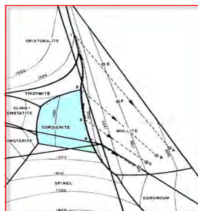
Figure IV.39 Position du spinelle et la mullite dans le syst me MgO-Al_2O_3-SiO_2 [146].
