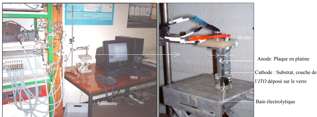
Figure 3.1 : Photographie du dispositif expérimental pour élaborer les couches minces de CuInSe_2 .
