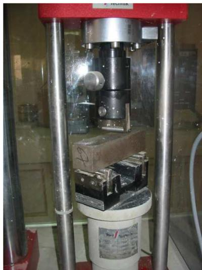
**Figure IV.12 :** Machine d'essai de résistance à la flexion [5].
