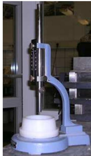
**Figure. IV.4 :** Appareil de Vicat muni de la sonde de consistance [8].
