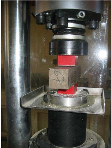
**Figure IV.13 :** Machine d'essai de résistance à la compression [5].
