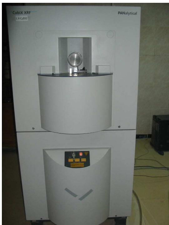
**Figure IV.18 :** Analyseur des RX [5].
