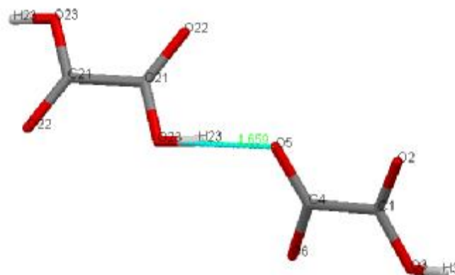
Figure 19 : distance de contact assurée par le groupement oxalate.
