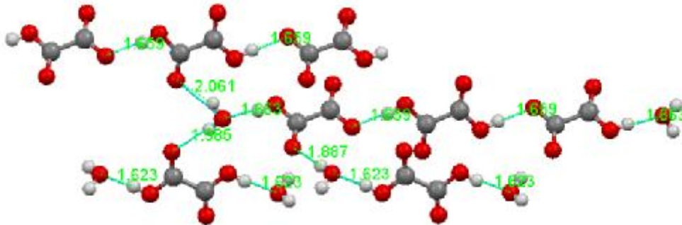
Figure 15 : Enchainement des groupements acides oxalate, d’hydrogènes oxalates et les molécules d’eaux par les liaisons hydrogène dans la structure de \text{NH}_4(\text{C}_2\text{HO}_4)(\text{C}_2\text{H}_2\text{O}_4).2(\text{H}_2\text{O})
