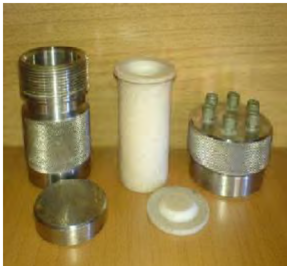
Figure II-1- schéma et photo simplifié d'un autoclave
