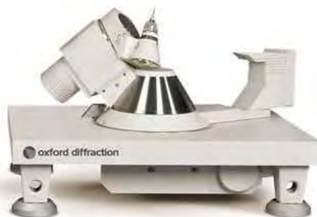
Figure-III-2- Goniomètre du diffractomètre Oxford
