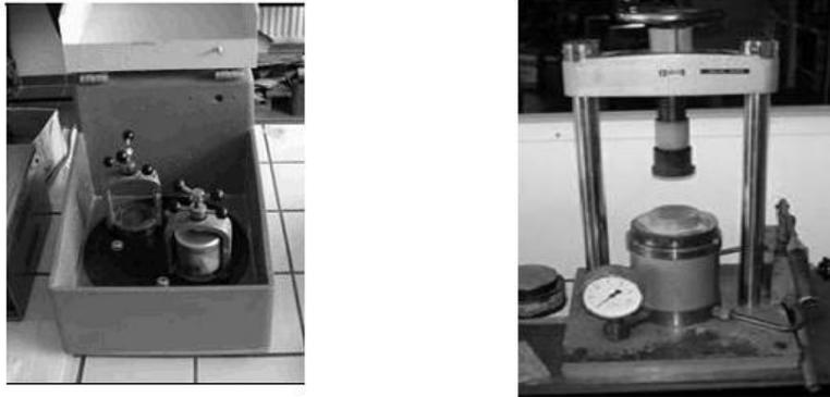
**Figure II.2:** broyeur planétaire et une presse.
