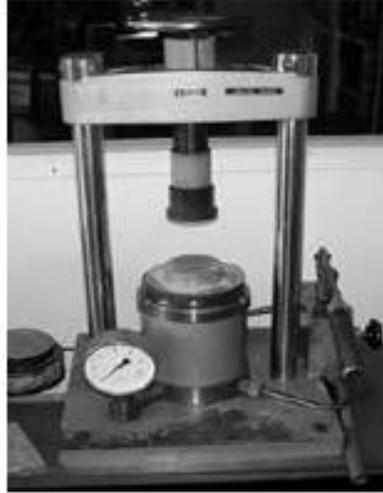
**Figure III.2:** La presse hydrostatique utilisée pour la préparation des pastilles.
