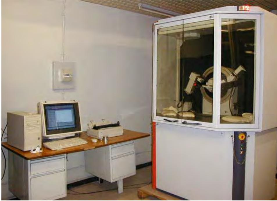
**Figure III.3:** Le diffractomètre utilisé de type Siemens D8.
