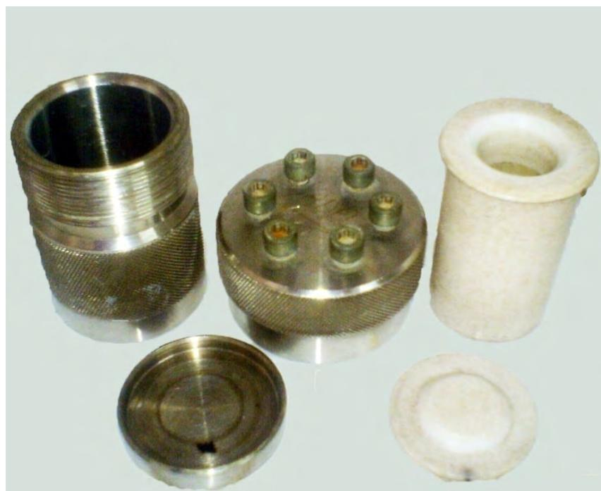
**Figure 7:** Schéma d'un autoclave avec chemise en téflon utilisé au laboratoire pour les synthèses hydrothermales.
