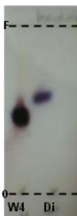
Figure 5: Chromatogramme de substance W 4 isolée du lot 16, cochromatographiées avec la digitoxine (Di) ; Eluant : (AE:MeOH ; 85 :15) ; révélation réactif de Kedde.
