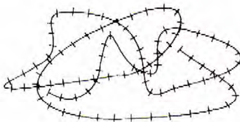
Figure III.1 : Représentation de la chaîne d'un polymère linéaire [79].
