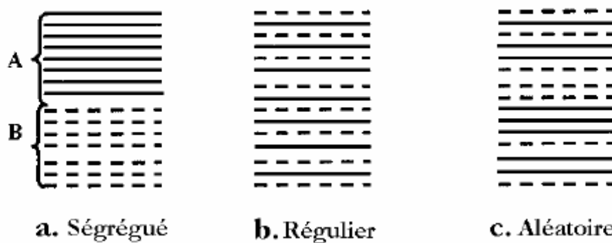
Fig. II.10 : Différents modes de succession des feuillets au sein d'une unité interstratifiée .
