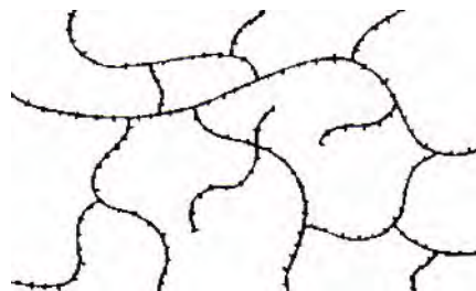
Figure III.3 : Représentation schématique d'un polymère Tridimensionnel [79].
