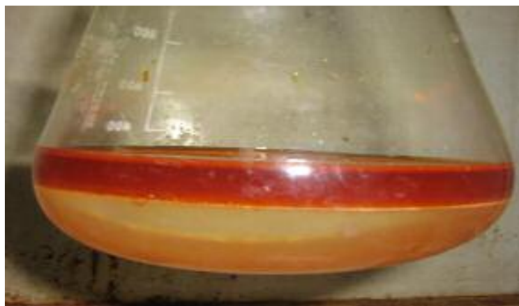
Figure IV.2 : Cellulose solubilisé dans le CS_2 (pâte de xanthate).
