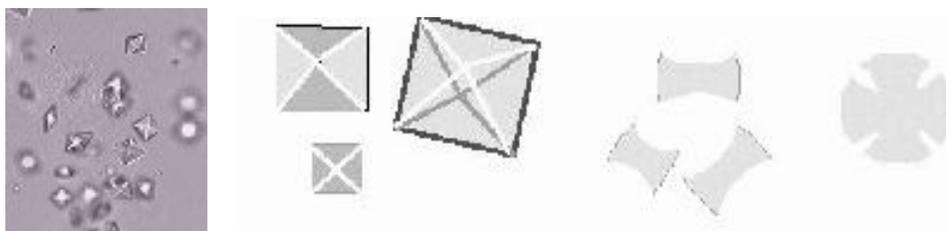
La Weddellite ou oxalate de calcium dihydraté  $\text{CaC}_2\text{O}_4, 2\text{H}_2\text{O}$  cristallise dans le système tétragonal. Avec les paramètres de maille suivante :  $a = 12.371\text{\AA}$ ,  $c = 7.357\text{\AA}$ , et  $\alpha = 90^\circ$  [1].
