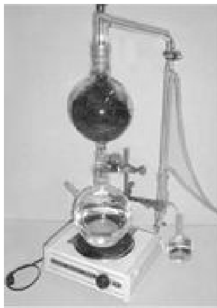
Fig. n°4: Montages de distillation: a- l'hydrodistillation. b- distillation par entraînement à la vapeur.
