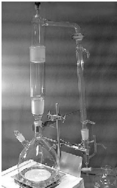
Fig. n°4: Montages de distillation: a- l'hydrodistillation. b- distillation par entraînement à la vapeur.
