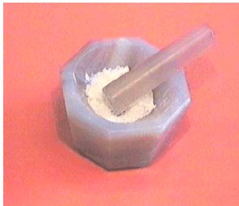
***figure II-10 :broyage au mortier***
