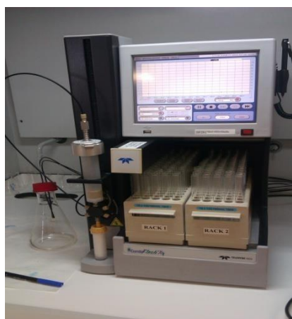
Figure 20 : Appareil Flash chromatographie. (Original).
