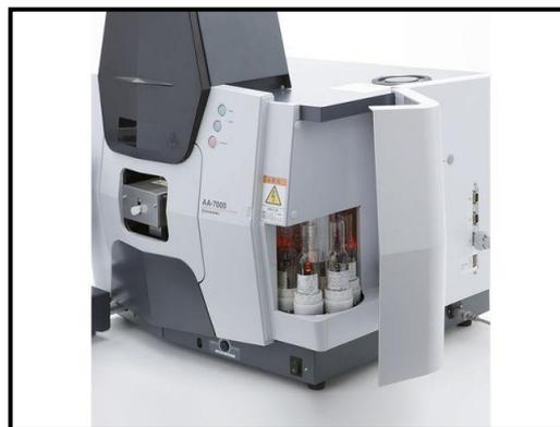
Spectrophotomètre d'absorption atomique
