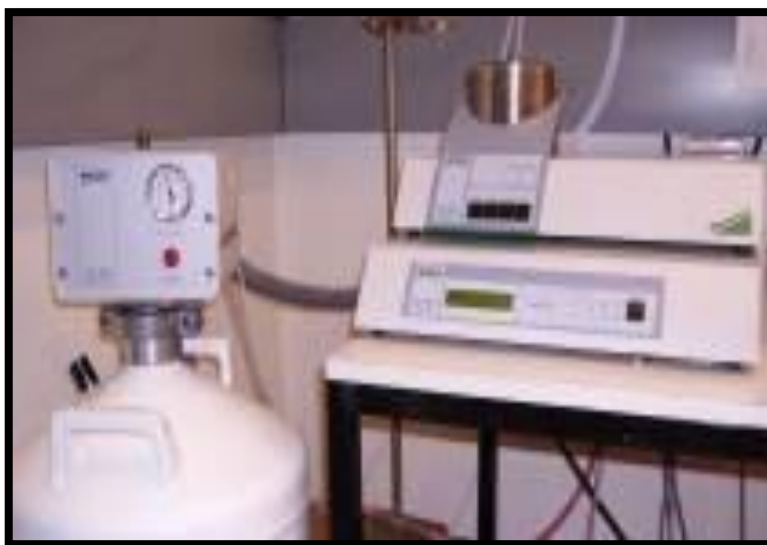
Figure (5) Photo d'un DSC 204 NETZSCH à flux de chaleur.
