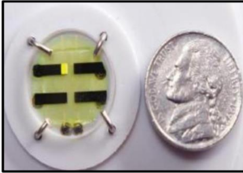
Figure (9) Dispositif « OILED » opérationnel basé sur la pérovskite hybride ( C_{20}H_{22}S_2N_2 ) [ PbCl_4 ] comme matériau émetteur 45 .
