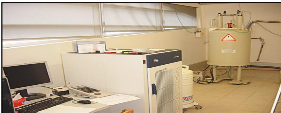
Figure (2) Photo d'un Bruker Avance 400 Systèmes de variations de température contrôlée par ordinateur.
