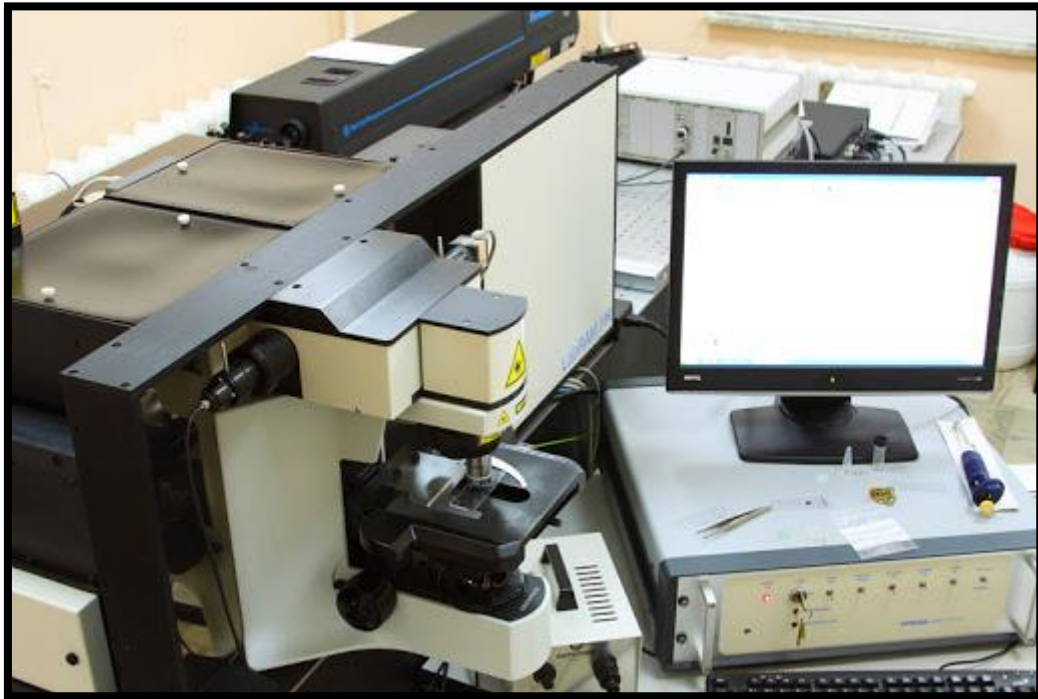
Figure (3) Photo d'un spectromètre Raman LABRAM -800 Horiba Jobin et Yvon.
