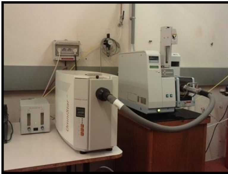
Figure (4) Photo d'une thermobalance PERKIN ELMER DIAMOND TG/TDA.
