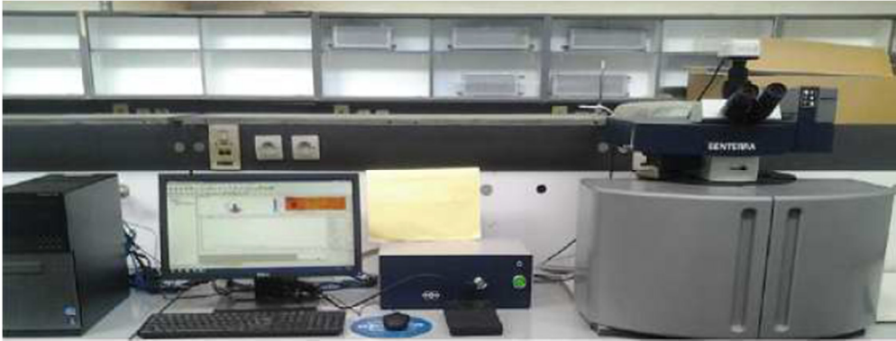
Figure I-4 : Spectrophotomètre \mu -Raman
