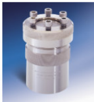
Figure I-9 : Autoclave utilisé au laboratoire pour les synthèses hydrothermales.
