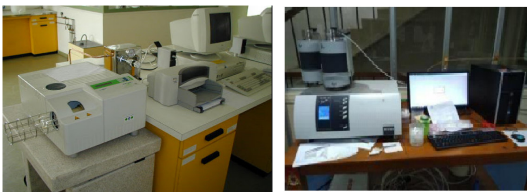
Figure I-7 : Deux thermobalances utilisés :
