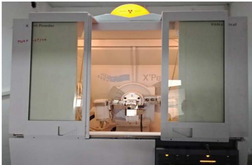
Figure II. 7: Diffractomètre à poudre.
