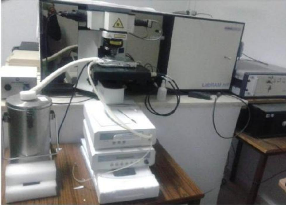
Figure II. 9: Spectromètre Raman
