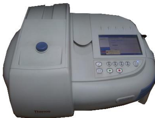
Figure II.4. Spectrophotomètre UV-visible «Thermo scientific».
