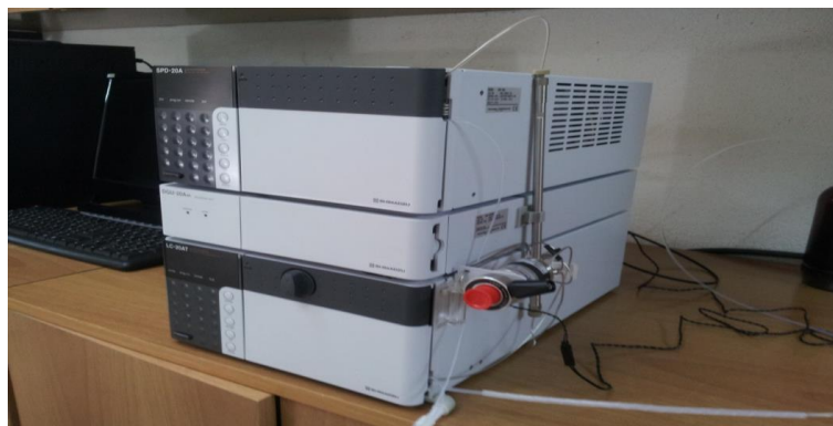
Figure II.5. Chromatographie liquide à haute performance Shimadzu LC20
