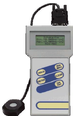
Figure II.6: Radiomètre VLX-3W de marque Vilber Lourmat équipés des sondes.
