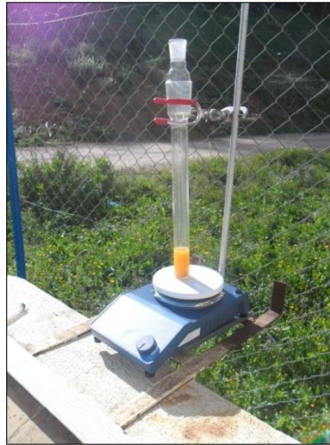
Figure II.2 : Montage expérimental du système d'irradiation solaire.
