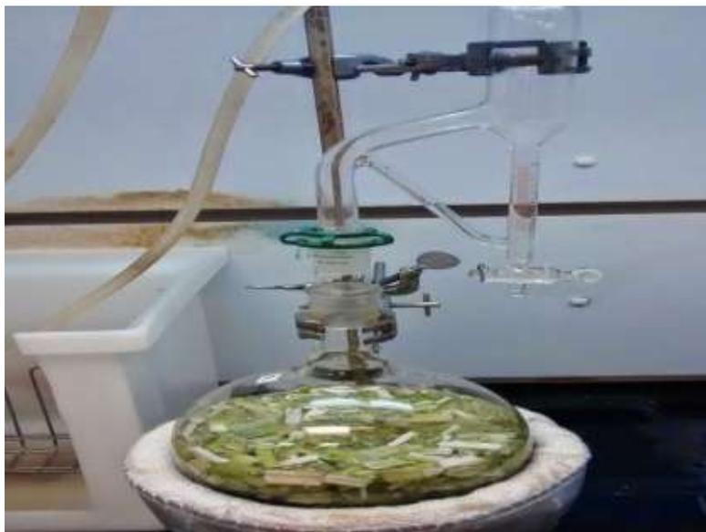
Figure 15 : Montage d'extraction de type Clevenger.
