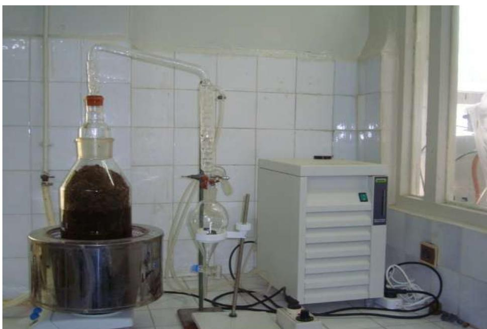
**Figure 50 : Montage utilisé pour l'extraction des huiles essentielles**
