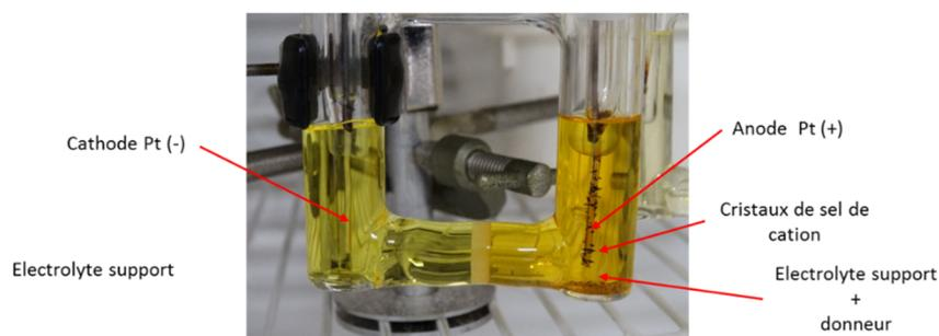
Figure : Photo d'une cellule d'électrocristallisation.
