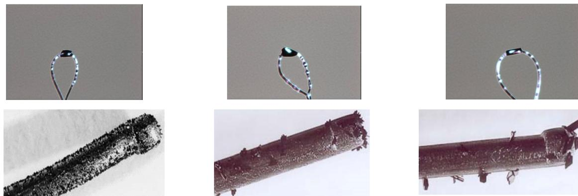
Figure IV-7 : Images des cristaux sur une électrode de platine et un monocristal monté sur une boucle
