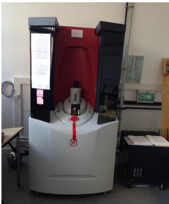
Figure 8. Magnétomètre à SQUID Quantum Design MPMS.
