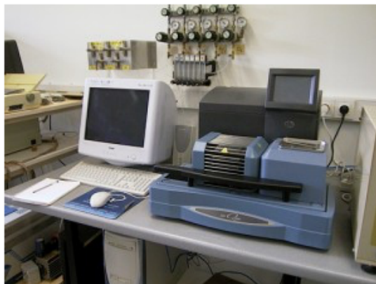
Figure 6. Analyseur Thermogravimétrique TA instruments
