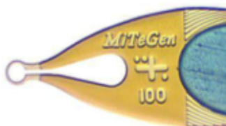
Figure 2. Photo de la Micro-loop MiTeGen.
