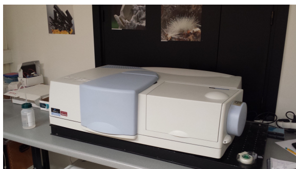
Figure 5. Spectrophotomètre UV-Visible Perkin Elmer Lambda 950.
