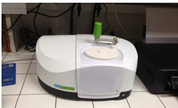
Figure 4. Spectromètre FT-IR Spectrum 2 Pékin Elmer.
