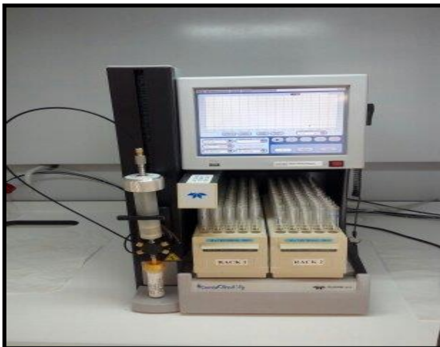
Figure II.8: flash chromatographique (modèle : COMBIFLASH RF200 UV/VIS, Serial : 210M20115).
