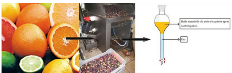
Figure 4. Montage d'expression à froid
