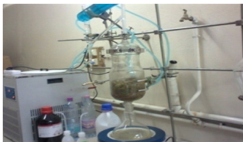
Figure 5. Protocole d'extraction par entraînement à la vapeur d'eau
