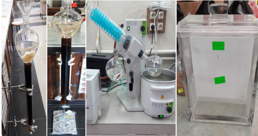
Photo 1. Colonne de gel de silice Photo 2. Un rota-vapeur Photo 3. La cuve
