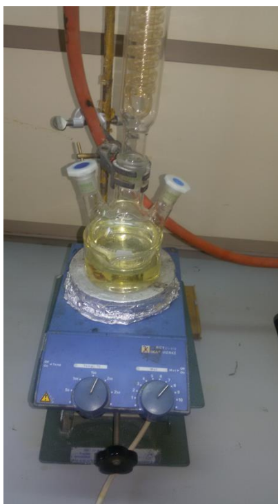
Figure III.3 Montage de réaction de fixation de l'amorceur à la surface du PVC
