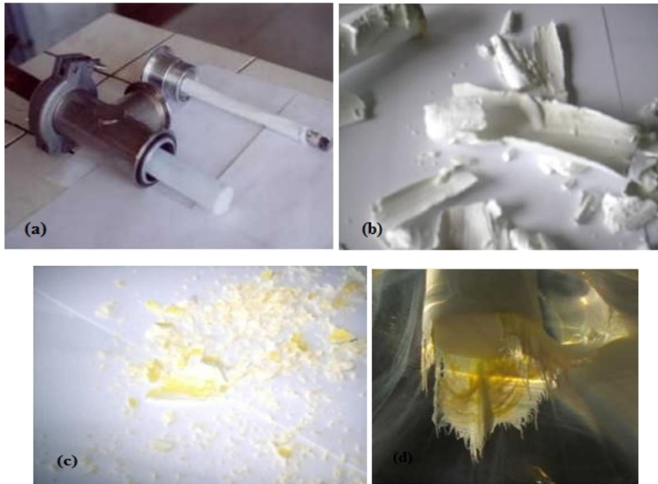
Figure D: (a) Vue de nanopoudres collectées sur le filtre céramique nanoporeux à droite et par condensation sur le doigt froid à gauche. (b) Aspect de nanopoudres de ZnO pur préparées par SPVD. (c) Aspect des poudres de ZnO dopée à l'oxyde de bismuth préparées par SPVD. (d) Aspect de dépôt sur le doigt froid nanopoudres de ZnO dopée à l'oxyde de bismuth préparées par SPVD (P= 80-100 Torr).
