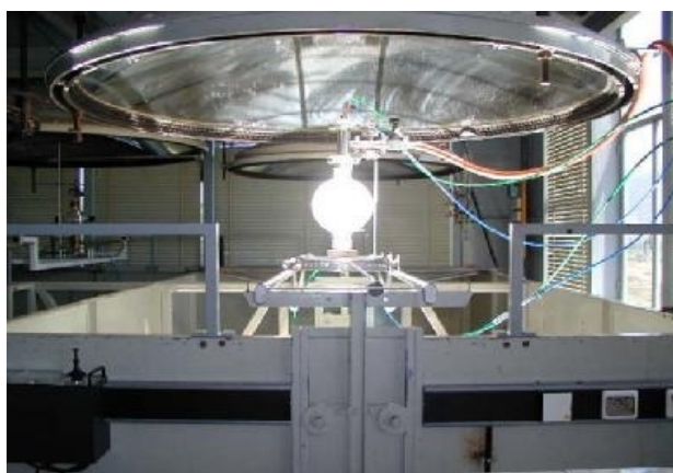
Figure A : Réacteur SPVD au foyer d'un four solaire de 2kW à concentrateur parabolique.
