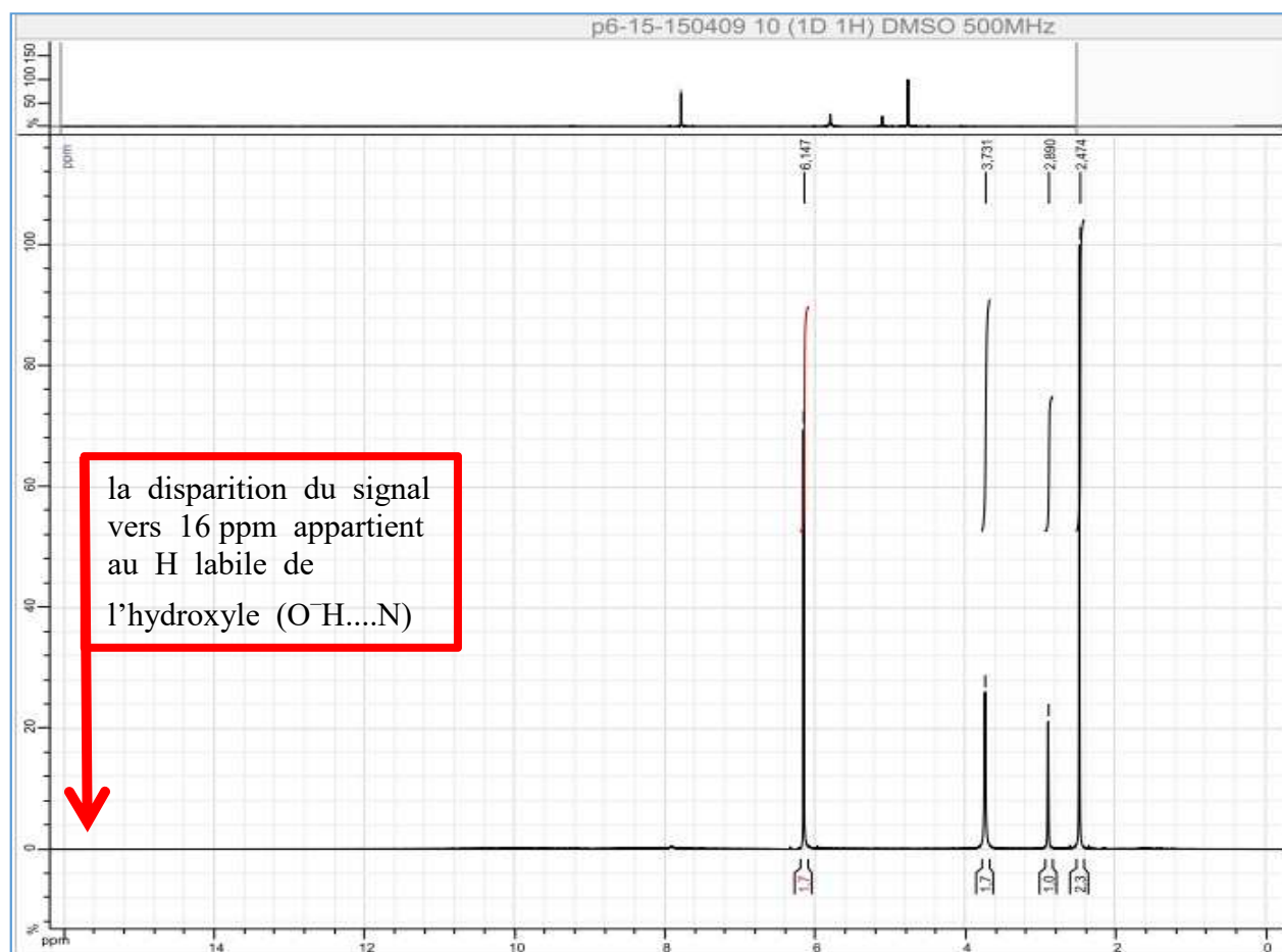
Figure II.2 : Spectre RMN 1H de proton du composé Tris[(E)-1-(2-méthylphénylazo)-2-naphtol] Cobalt(III)
