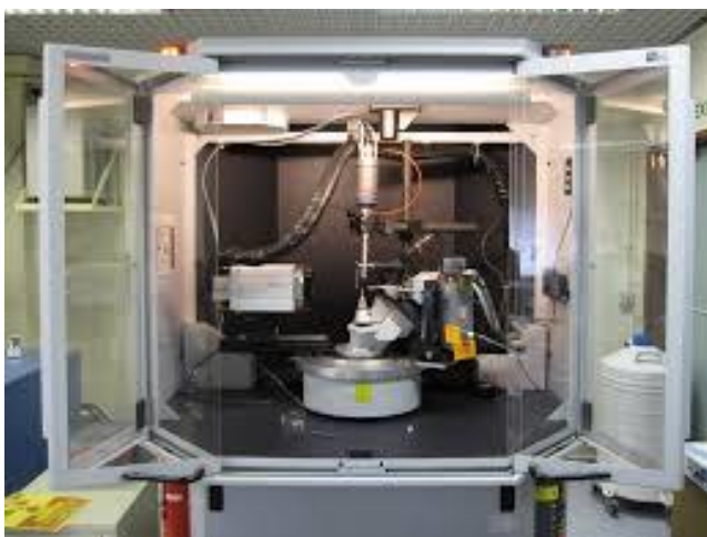
Figure II.1 : diffractomètre KAPPA de Bruker-APEXII à détecteur bidimensionnel
